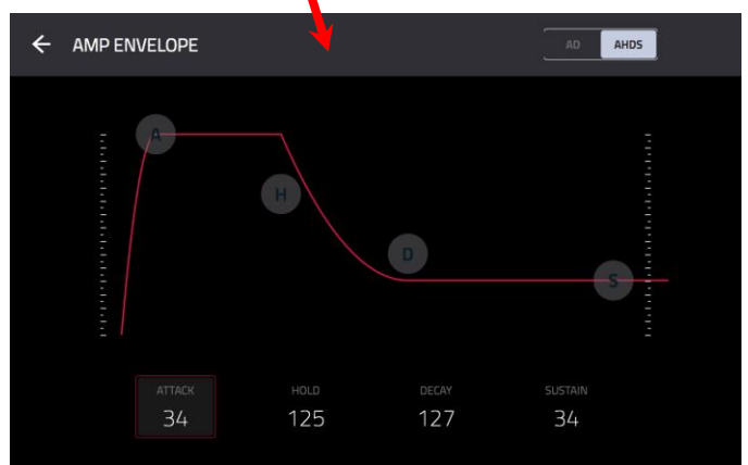
Gros plan sur une enveloppe d'ampli de type AHDS.
